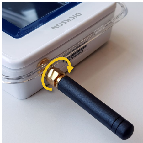
Figure 12 – Tournez l'anneau pour fixer l'antenne à l'enregistreur
