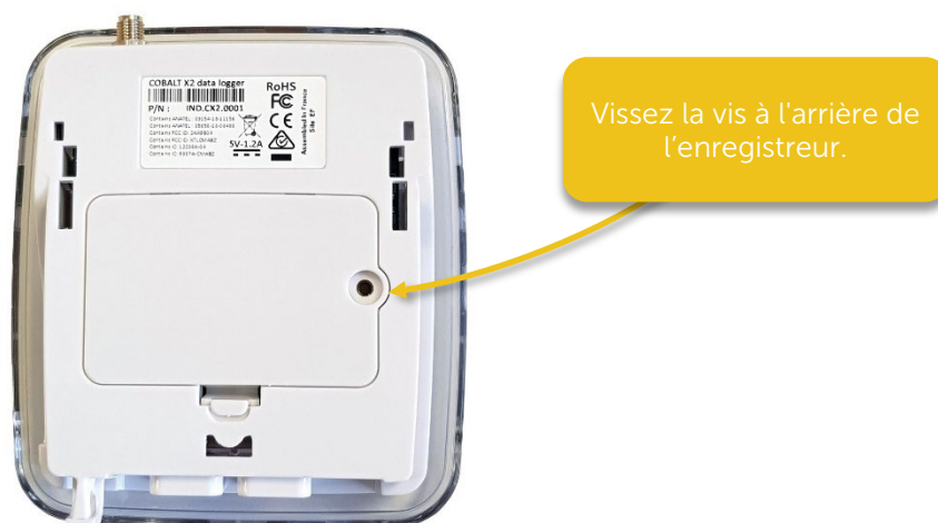
Figure 14 – Remettre le couvercle du compartiment à piles
