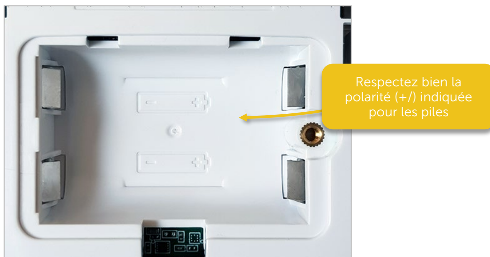
Figure 13 – Respecter les indications de polarité de la pile
