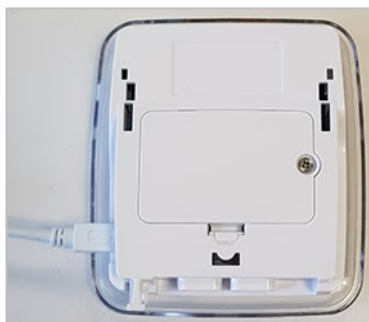
Figure 68 – Optionnel : brancher l'enregistreur sur secteur AC (USB) pour éviter de perdre les données enregistrées
