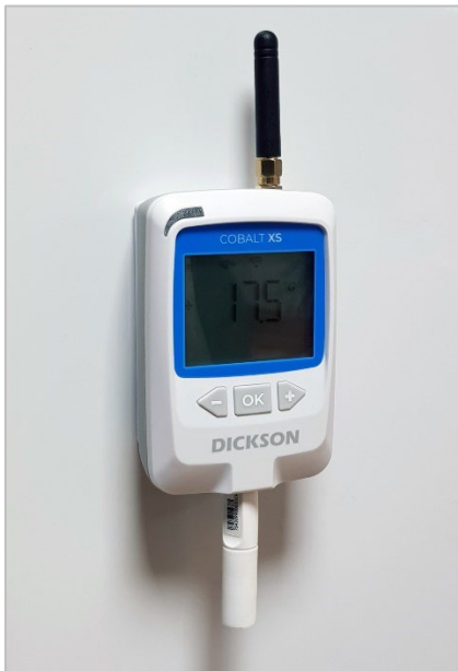
Figure 11 – Montage du Cobalt XS sur une surface métallique à l'aide d'aimants
