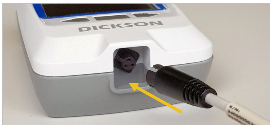
Figure 13 – Branchement d'un capteur sur l'enregistreur Cobalt XS
