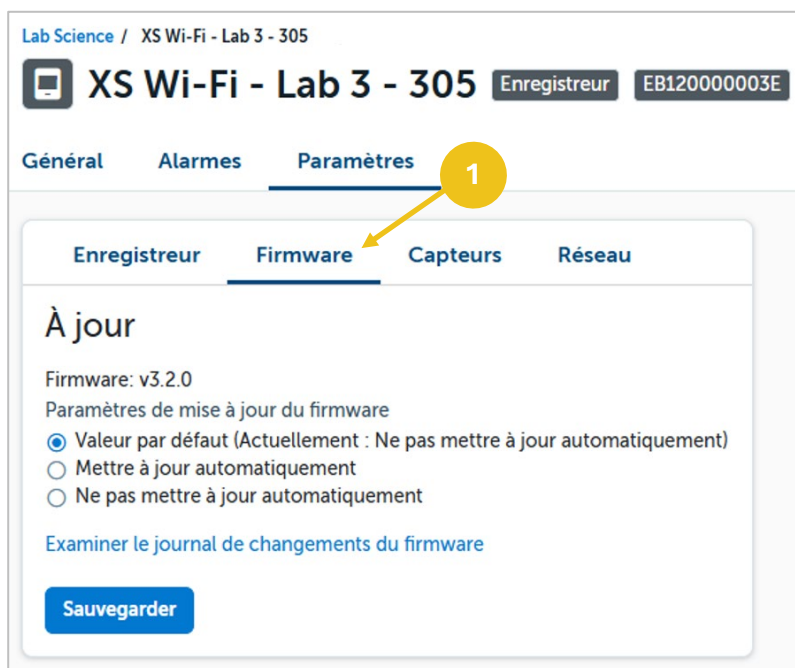
Figure 15 – Paramètres de mise à jour du firmware dans DicksonOne
