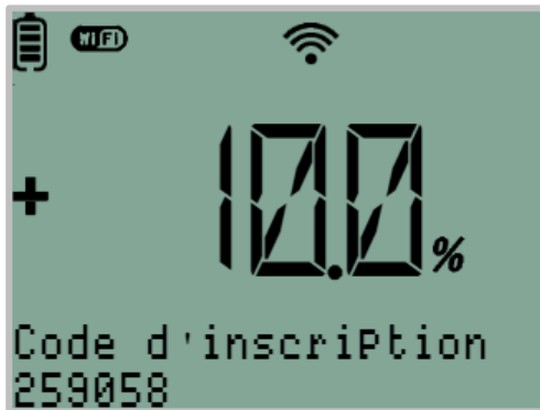
Figure 8 – Une fois la connexion établie, le code d'inscription et la mesure actuelle du capteur s'affichent
