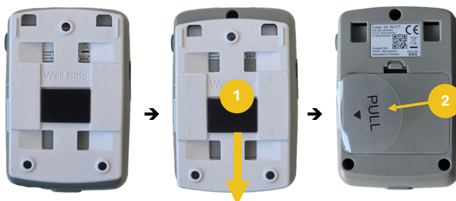
Figure 1 – Retirez le socle et retirez la languette pour activer les piles
